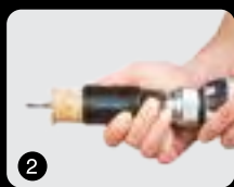
2 APPUYER SUR LE BOUTON ET TIRER LA SCIE À CLOCHE
